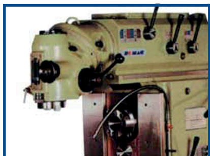
FUMC 45 Slittone motorizzato con testa birotativa e discesa del canotto mm 100 Motorized overarm multi-angle quill head
