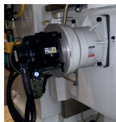
Motore brushless con riduttore asse "Z"
