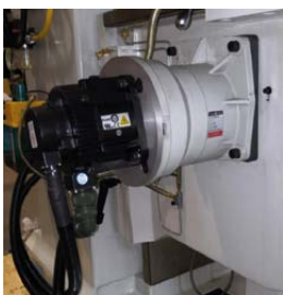
Motore brushless con riduttore asse "Z" Avanzamenti + rapidi sul verticale
