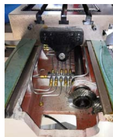
Lubrificazione guide automatica Copertura guide "Turcite B"
